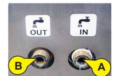
Pour le raccordement au réseau d'eau, il est recommandé d'utiliser des tuyaux en caoutchouc à des pressions jusqu'à 15 bars. Pour brancher les tuyaux aux raccords filetés de la machine, il est recommandé d'utiliser des raccords porte-caoutchouc de 3/4" et un collier serre-tube avec vis de serrage. Prévoir une vanne ou un robinet, avant le tuyau d'alimentation, afin de régler le débit de l'eau en entrée.
